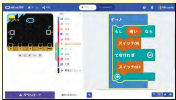
「『micro:bit』のセンサーで受けた光が暗いとき、リレーのスイッチを ON にして通電、それ以外は OFF とする」を繰り返す。
