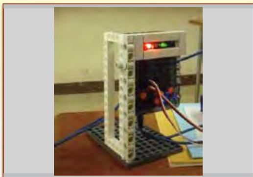
既定の信号機パーツを用いて信号機を組み立てた。児童の計画を実現できるよう、光センサー、赤外線センサー、音声機能をオプションで用意した。
